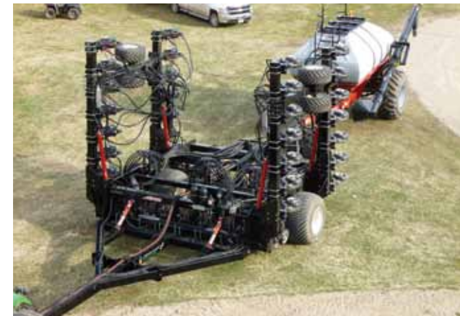
^ Linked wings with stabiliser wheels Ailes liées avec roues stabilisatrices Verbundene Flügel mit Stabilisator-Rädern Связанные крылья со стабилизирующими колесами
